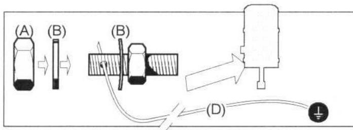
Allentare il dado di bloccaggio (A), passare tra le rondelle (B) l'estremità di un filo di terra (D) (sezione min.: 1,5 mm<sup>2</sup>) nel foro del terminale. Serrare il dado di bloccaggio. Raccordare l'altra estremità del filo ad una vera "terra" conforme alla normativa del paese di destinazione.
