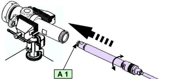
Avec précaution, introduire le piston dans le corps de l'hydraulique en faisant un mouvement de rotation de façon à préformer le joint.
