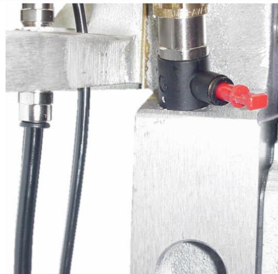
Tutti i motori assemblati in fabbrica sono cablati in pilotaggio standard. La soglia di avvio del motore è di circa 1,5 bar.
