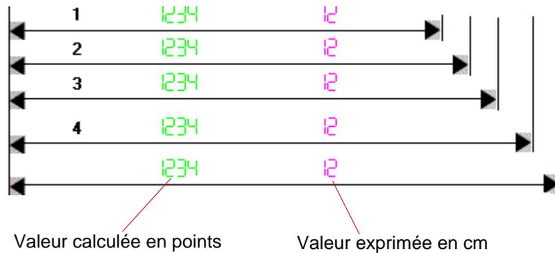
1 : Position qui correspond à l'occultation de la cellule la plus éloignée de l'axe du convoyeur.
